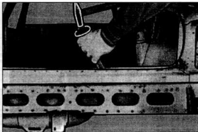
Рис. 9.113. Отделение задней юбки от поперечины пола
