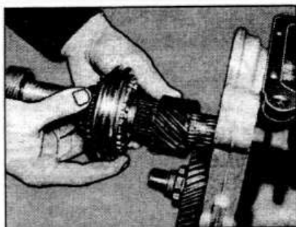
Рис. 4.13. Снятие синхронизатора и шестерни V передачи
