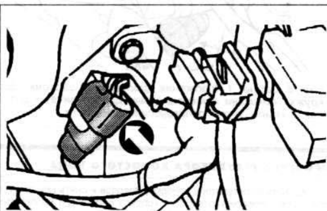
Рис. 11. Стрелкой показан разъем электромагнитного клапана продувки адсорбера
