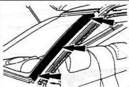
Рис. 9.33. Места крепления молдинга заднего углового стекла
